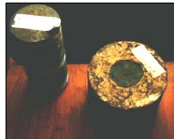
Gambar 4. Specimen (core sample) dengan anomaly lubang terletak ditengah
