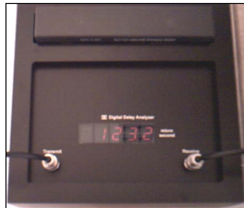
Gambar 2. Hasil digitasi waktu tempuh gelombang pada LCD
